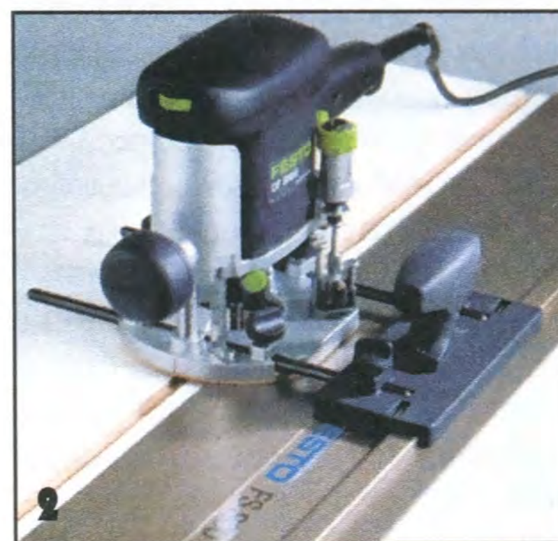
2 Направляющей шиной пользуются, когда упор не обеспечивает необходимых условий обработки.
