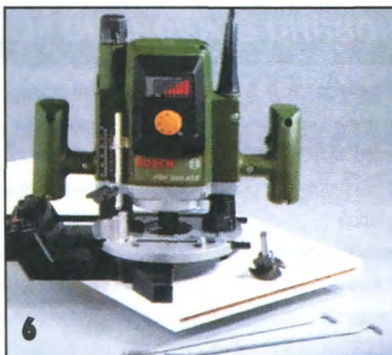
6 Паз под кронштейны, крепящиеся впотай, выбирают дисковой фрезой. Глубина паза определяется диаметром фрезы и установкой параллельного упора.
