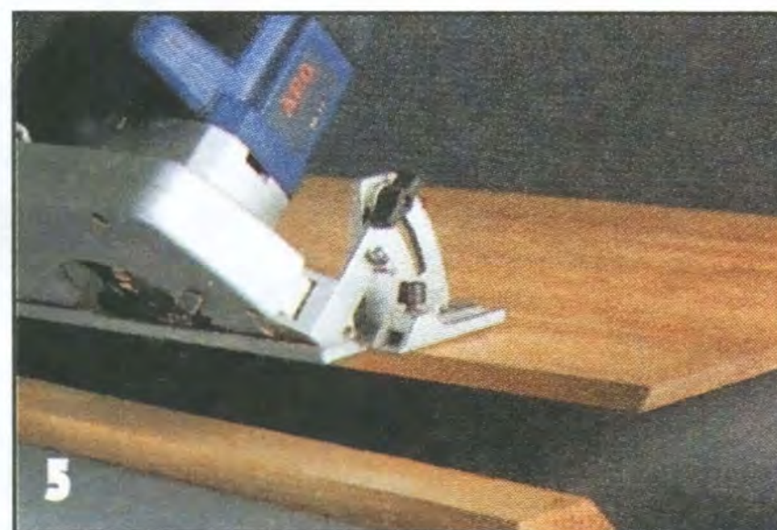
5 Кромки цокольных деталей и крышки с помощью ручной дисковой пилы скашивают под углом 45°, а затем слегка скругляют.
