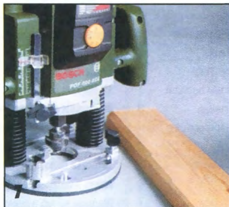
7 Фреза для снятия фасок с упорной цапфой. Здесь не нужны какие-либо упоры и направляющие. Высота фаски определяется глубиной прохода.
