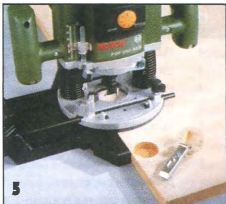
5 Выборка нескольких отверстий под мебельные петли с использованием параллельного упора. Диаметр таких отверстий обычно — 26 и 35 мм.
