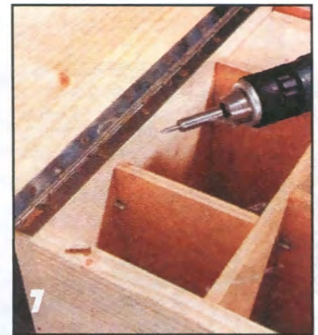
На левую боковую стенку на рояльной петле из латуни навешивают дверку. Петлю крепят шурупами длиной 15 мм.
