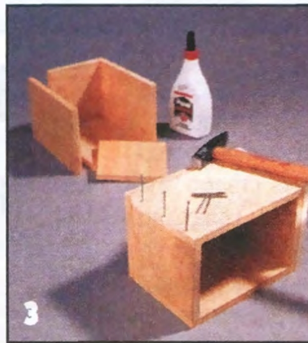
Детали выдвижных ящичков (размеры 115x115x170 мм) соединяют на клею и гвоздиках. Дно вставляют в пазы стенок.
