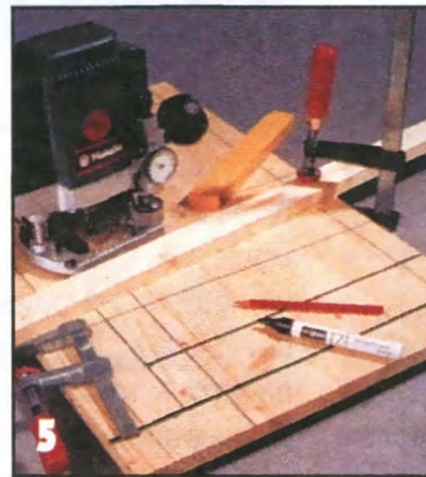
На дверке шкафчика пазовой фрезой выбирают бороздки, оставляя свободным достаточно большой участок для буквы А (здесь его размеры — 150x150 мм).
