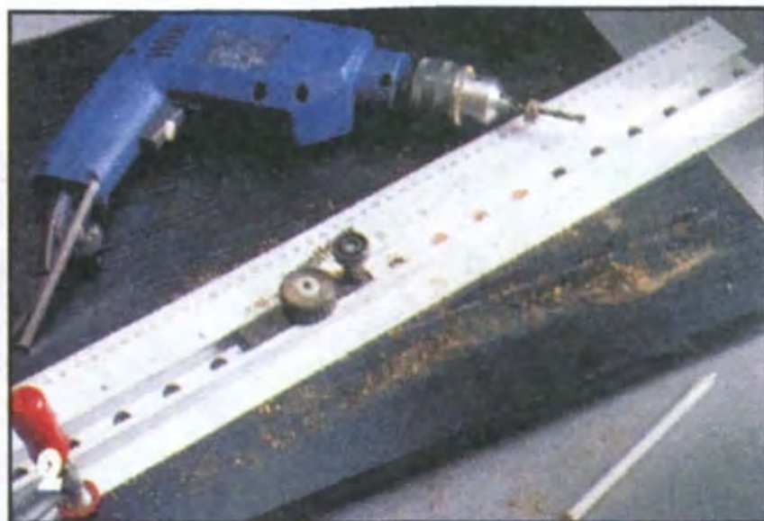
Расстояние между полками при необходимости можно изменять. Отверстия под полкодержатели сверлят по кондуктору или по разметке с шагом 32 мм.
