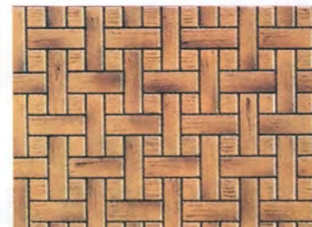
Паркет с плетеным орнаментом. Из одной клепки вырезают три квадрата, заполняющие пространства между «крестами».
