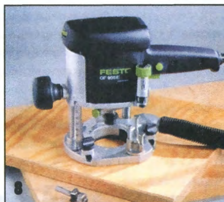
8 Скругление кромок без упора. И эта фреза направляется упорным подшипником.
