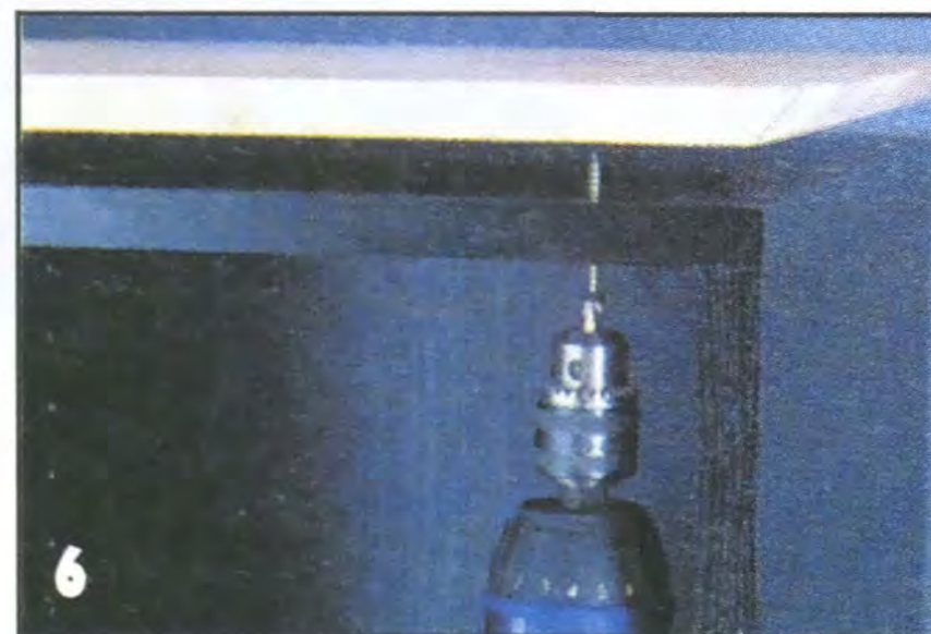
6 Изготовленную из столярного щита крышку кладут на собранный корпус и снизу крепят шурупами.
