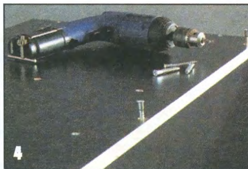
4 Заднюю стенку из ДСП толщиной 19 мм соединяют с боковыми стенками, нижней полкой и крышкой ступенчатыми мебельными шурупами.
