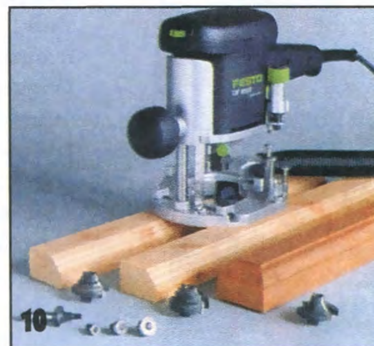
10 Различные фасонные фрезы и результаты их применения. Обработка выполняется за один проход. Отступ от края определяется сменными упорными подшипниками различных размеров.
