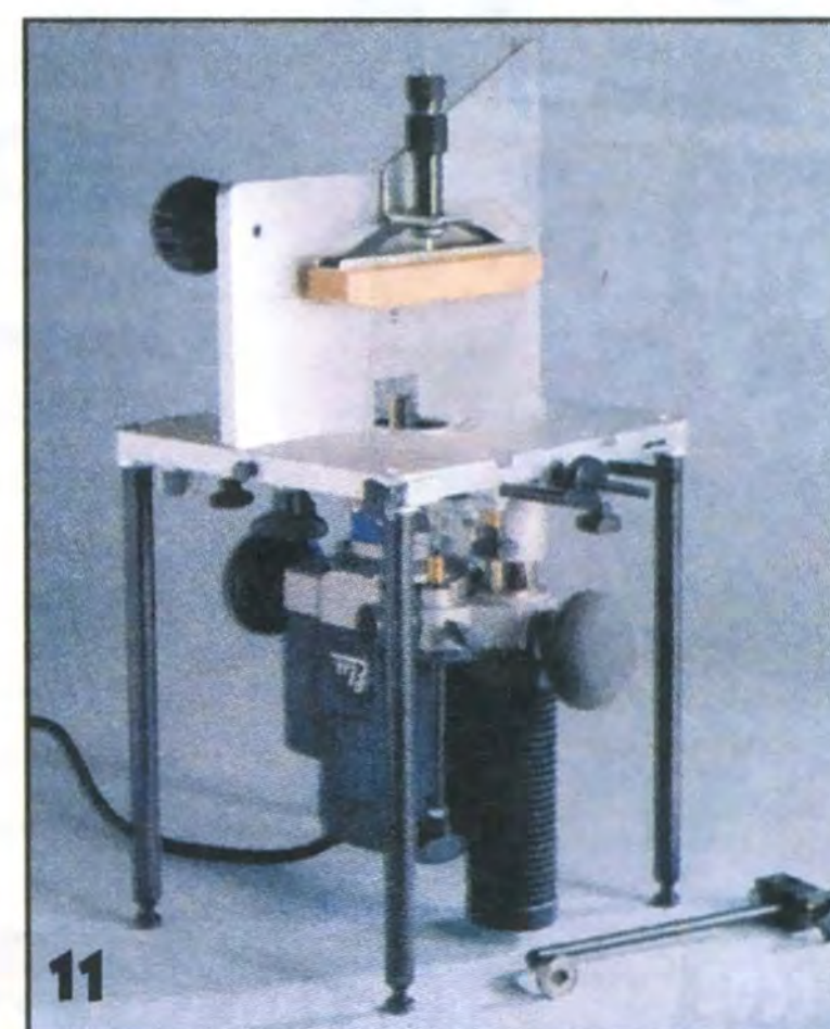
11 Превратив ручную фрезерную машинку с помощью такого приспособления в стационарный станок, можно обрабатывать небольшие или узкие, наподобие реек, заготовки. Предохранительный упор прижимает заготовку к столу, если установить его сбоку направляющей.
