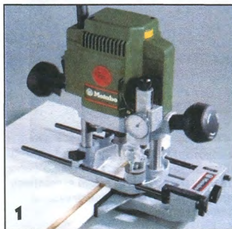
1 Точную регулировку параллельного упора выполняют с помощью юстировочных винтов. Вылет фрезы выставляют по стрелочному индикатору.
