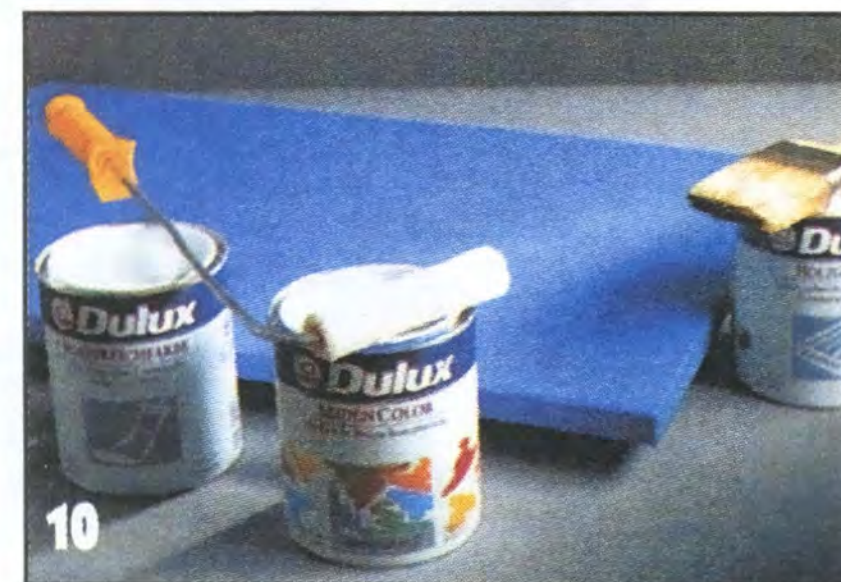
10 Поверхности шкафа сначала грунтуют, затем красят, шлифуют и покрывают лаком.
