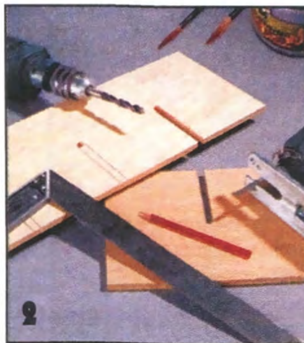
Верхние полки соединяют с перегородками врубкой вполдерева, а нижние — вставляют отдельно.
