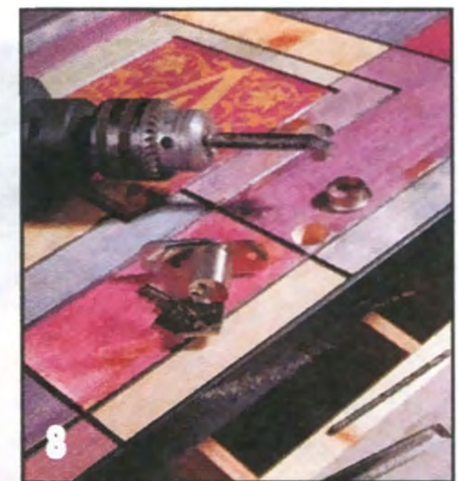
Рычажно-цилиндровый замок Ø18 мм вставляют в отверстие Ø20 мм и фиксируют крышкой.
