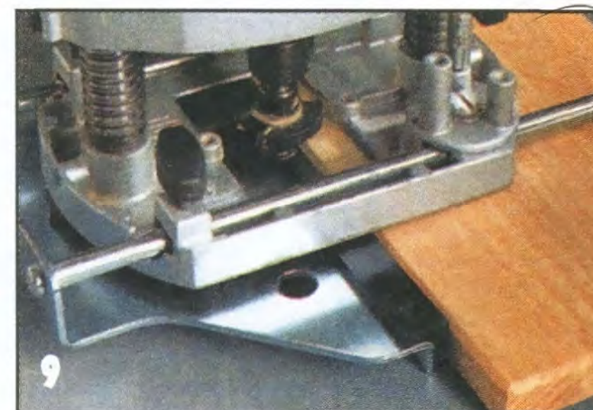
9 На кромках лицевых панелей выдвижных ящиков снимают небольшую фаску, пользуясь рубанком или фрезерной машинкой и шлифовальной шкуркой.
