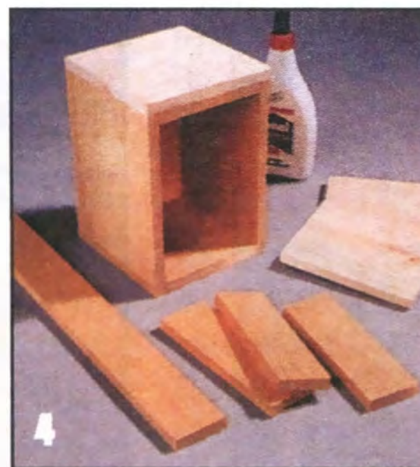
Лицевые панели выдвижных ящичков делают из сосновой доски толщиной 10 мм. Спереди крепят мебельные ручки.
