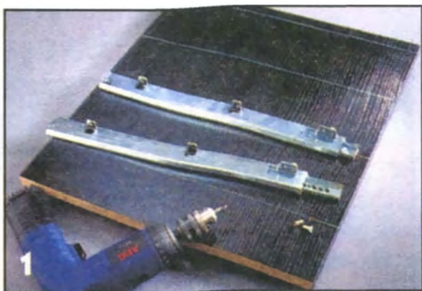
Телескопические направляющие для выдвижных ящиков лучше прикрепить изнутри к боковым стенкам корпуса еще до его сборки.
